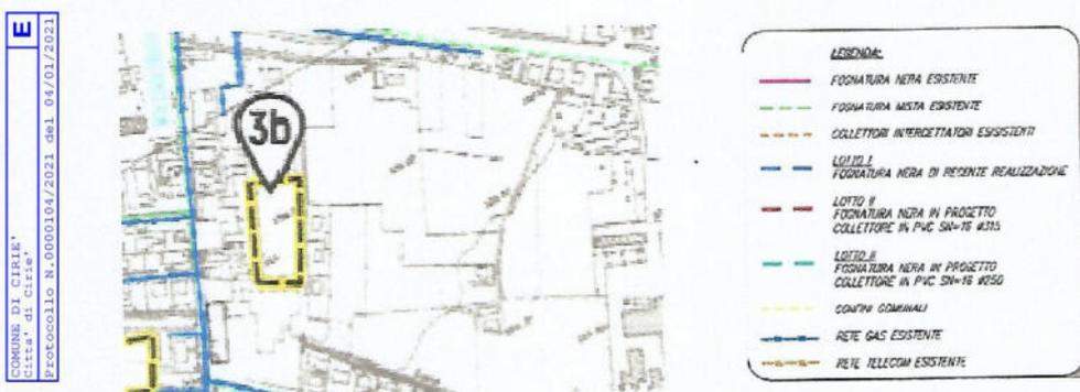
Fig. n.3: Tracciato delle reti dei sottoservizi nell'area individuata.
